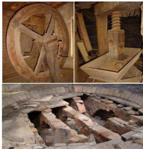
Figura 06 – Instrumentos utilizados no preparo da farinha, com destaque para a roda, a prensa e o forno onde ocorria a queima
