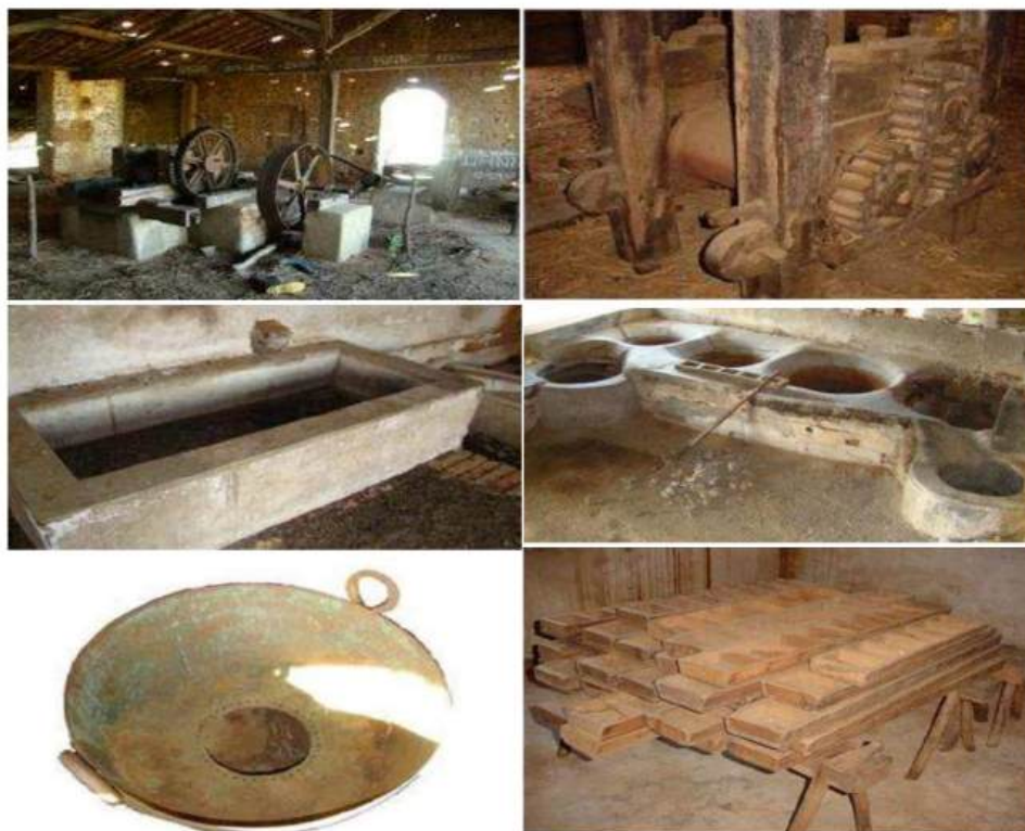
Figura 08 – Instrumentos utilizados para o preparo da rapadura, com destaque para a moenda, o parol, a alvenaria onde se realizava o cozimento com fogo a lenha, o tacho e as formas da rapadura
